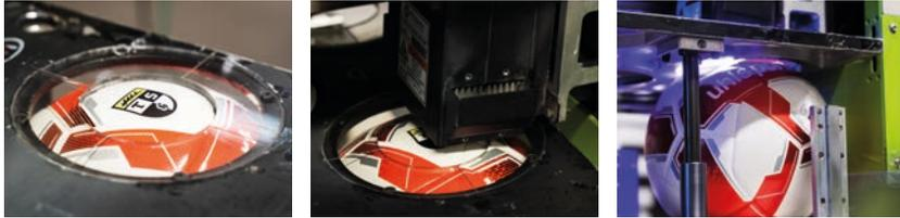
Le logo est imprimé directement sur la surface du ballon à l'aide d'une imprimante à jet d'encre UV.
